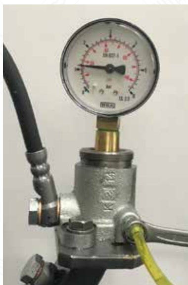
Fig. 7 e 8: Possibile accumulo di pressione prima dello spurgo e dopo lo spurgo.
