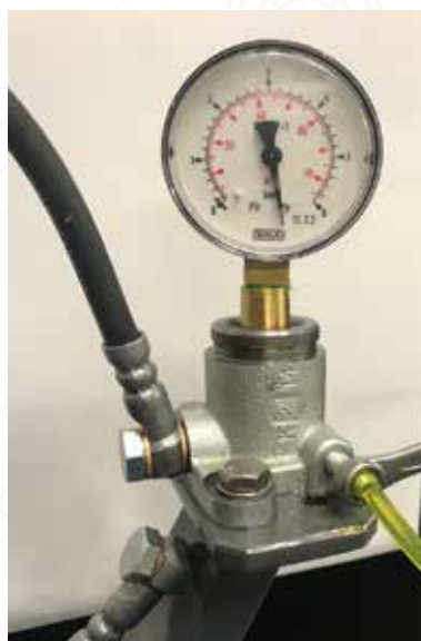
Fig. 7 e 8: Possibile accumulo di pressione prima dello spurgo e dopo lo spurgo.
